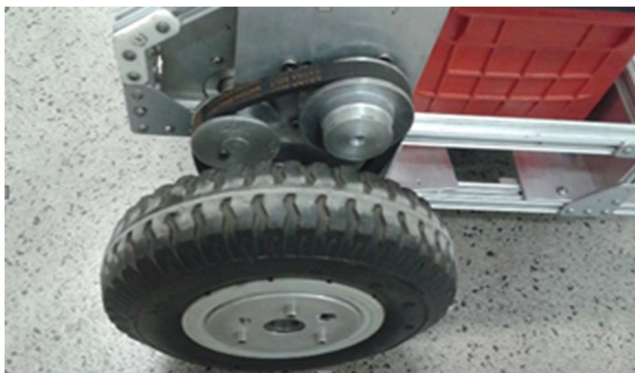
Figura 2 – Detalhe do sistema de transmissão
