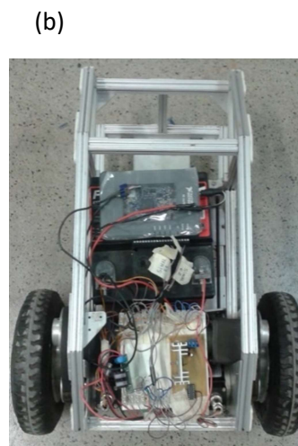
b) Robô móvel protótipo diferencial
