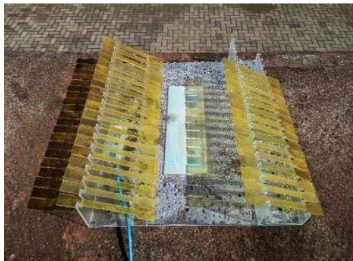
Figura 8 – Instalação do sensor no tanque de umidade constante
