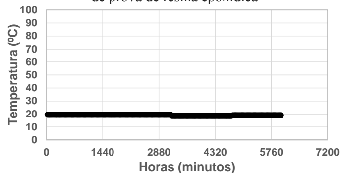
Figura 10 – Curva de temperatura versus horas de exposição em umidade constante dos corpos de prova de resina epoxídica
